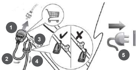
Рис. 8 Фиксация кабеля удлинителя на рабочей рукоятке.
