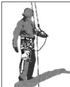
Рис. 19 Пример крепления пилы к ремню оператора
