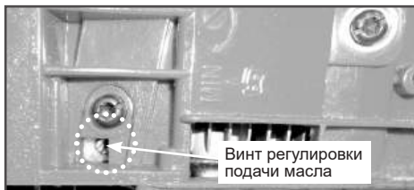
Рис. 11 Расположение регулировочного винта подачи масла
