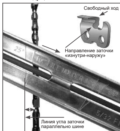
Рис. 28 Определение угла заточки
