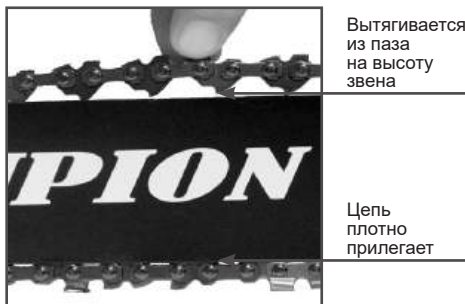
Рис. 5 Регулировка натяжения цепи
