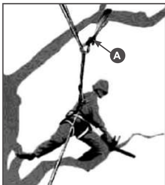
Рис. 21 Положение оператора при горизонтальном пилении
