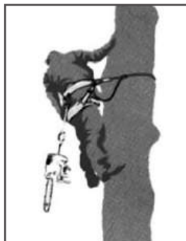
Рис. 20 Крепление бензопилы к задней средней точке ремня
