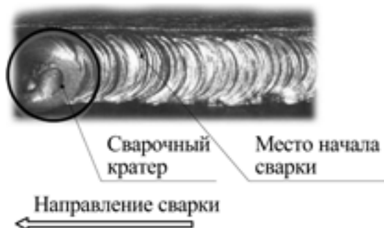
Рис. 7.5. Начало сварки при смене электрода.
