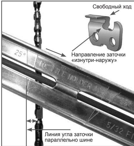
Рис. 16 Определение угла заточки
