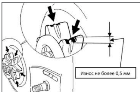
Рис. 14 Проверка износа звездочки
