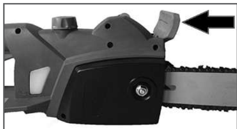
Рис. 7 Отключение тормоза цепи
