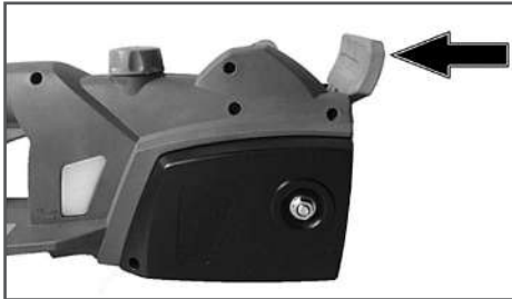
Рис. 2 Отключение тормоза цепи
