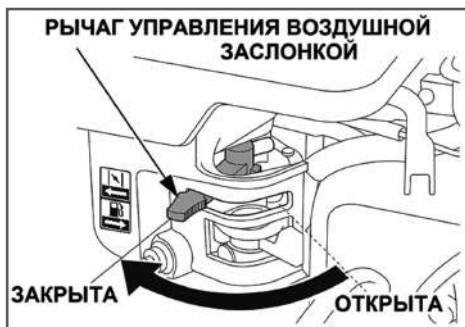
Рис. 11 Воздушная заслонка закрыта
