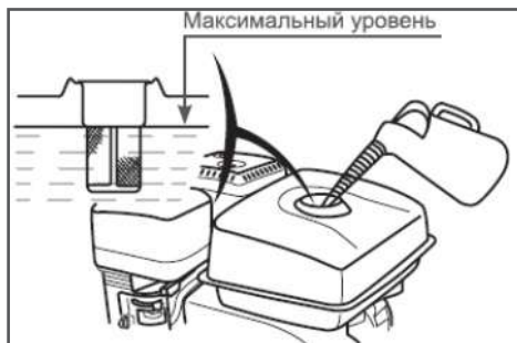
Рис. 7 Максимальный уровень топлива в топливном баке
