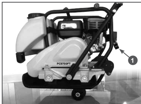
Рис. 26 Использование транспортировочной тележки 1. Зажим
