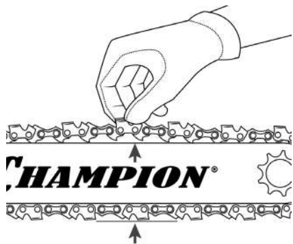
Рис. 5 Проверка натяжения цепи
