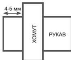
Рис. 6 Расположение хомута на рукаве
