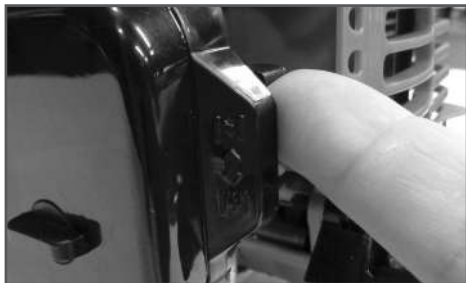
Рис.9 Закрытие воздушной заслонки
