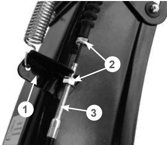
Рис. 21 Установка оболочки троса управления дефлектором жёлоба
