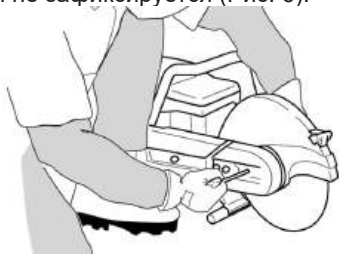
Рис. 6 Блокировка вращения диска
