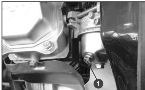
Рис. 20 Слив топлива из карбюратора 1. Болт сливной
