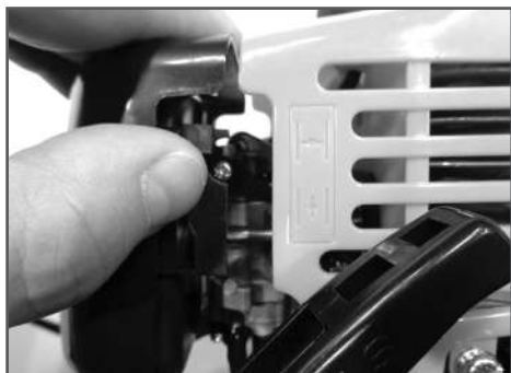
Рис.10 Закрытие воздушной заслонки
