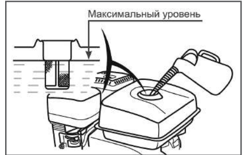
Рис. 6 Максимальный уровень топлива в топливном баке
