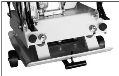
Рис. 24 Использование транспортировочной тележки
