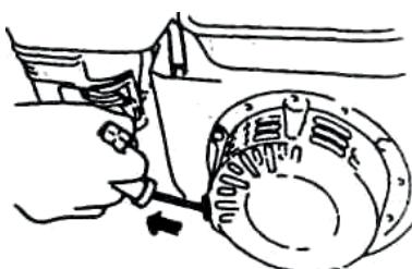
Производитель поставляет швонарезчик с предварительно обкатанным двигателем, состояние которого позволяет незамедлительно приступить к работе сразу же после заливки масла и топлива. Однако, с целью окончательного устранения остатков консервационной субстанции с кривошипно-шатунного механизма, после первых 5-ти часов работы следует заменить масло на новое (в двигатель заливается моторное масло SAE 10W30).
