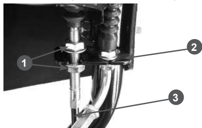
Рис. 10 Крепление оболочки троса включения хода
