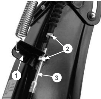
Рис. 21 Установка оболочки троса управления дефлектором жёлоба
