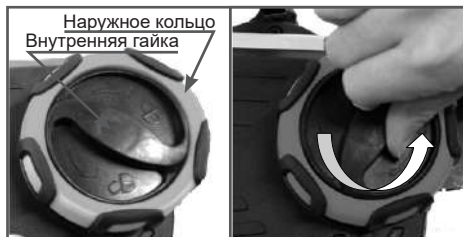
Рис. 3 Регулятор натяжения цепи / гайка крышки шины
