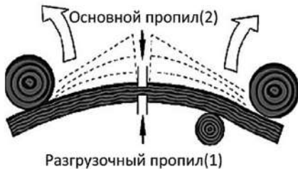
Рис. 14. Распиливание дерева, когда оба конца дерева зажаты и находятся под напряжением
