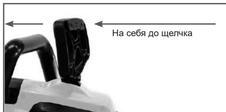
Рис. 2 Положение ручки тормоза цепи
