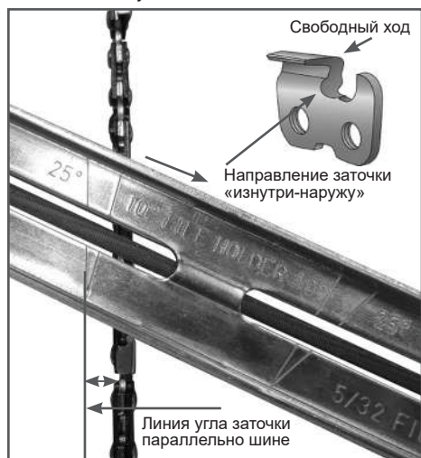
Рис. 17. Определение угла заточки
