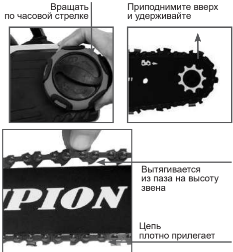
Рис. 6 Регулировка натяжения цепи
