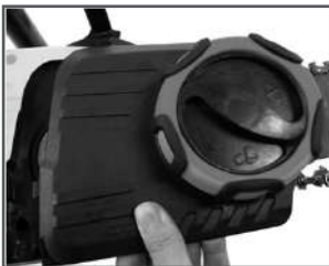
Рис. 5 Установка крышки шины
