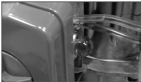
Рис. 7 Ручной топливный насос
