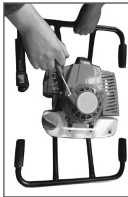
Рис. 9 Свободный ход шнура стартера
