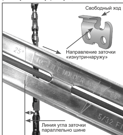
Рис. 18 Определение угла заточки
