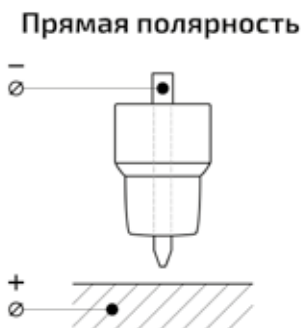
Рис. 9.2.1. Полярность при TIG сварке.
