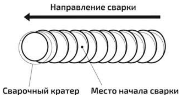
Рис. 11.1.2. Начало сварки при смене электрода.
