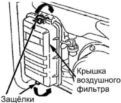
Рис. 14 Снятие крышки воздушного фильтра
