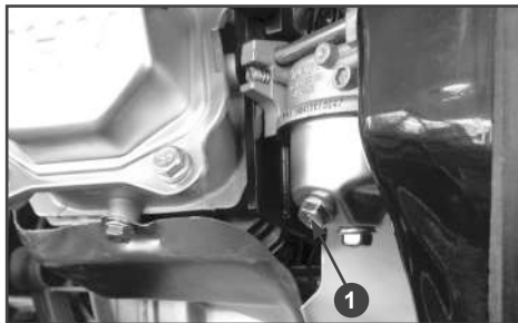
Рис. 20 Слив топлива из карбюратора 1. Болт сливной
