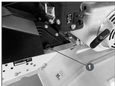
Рис. 24 Расположение пробки отверстия для добавления смазки в редуктор
